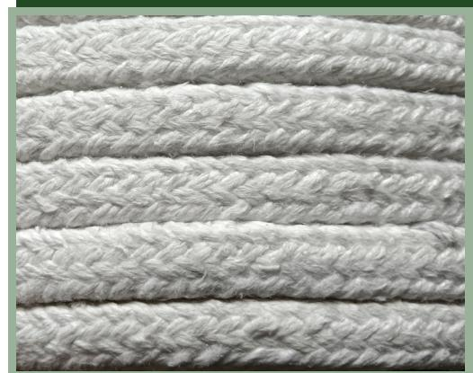
**CERAMIC FIBER YARN SQUARE ROPE IS ECO FRIENDLY & SUBSTITUES OF ASBESTOS SQUARE ROPE.**
